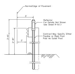
TYPICAL GUARDRAIL-GUIDE POST INSTALLATION
